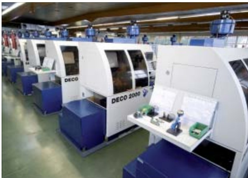
L'usine de décolletage de la rue du Bargy à Marnaz est équipée d'un impressionnant parc d'une quarantaine de tours CN du constructeur suisse Tornos.
